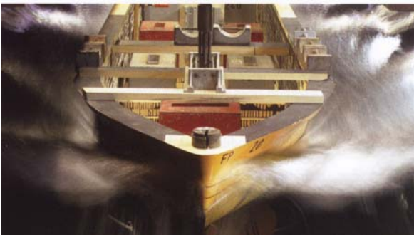
Bild 1.3.3-1 Modellversuch für Widerstandsprognosen
