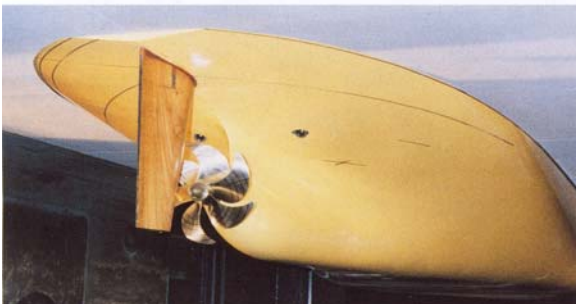
Bild 1.3.2-1: Modell für Propulsionsversuche
