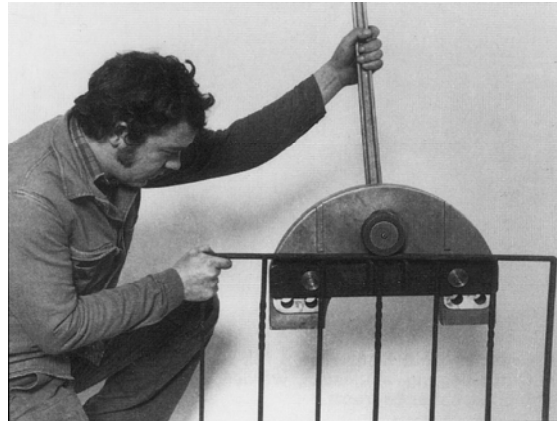
Bild a: Richten eines Handlaufs
